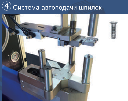
FH: M3-6~25 мм / M4-8~25 мм / M5-10~25 мм / M6-10~25 мм / M8-15~25 мм
